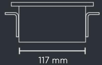
Su montaje requiere de un orificio de 120 x 53 mm.
