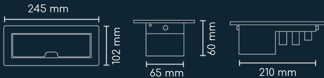
Su montaje requiere de un orificio de 220 x 68 mm.
