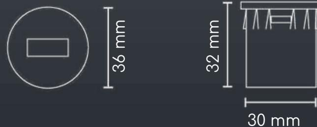
Su montaje requiere de un orificio de 32 mm (1 - 1/4") de diámetro.
