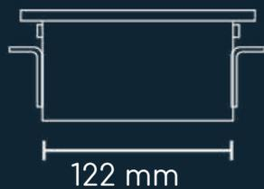
Su montaje requiere de un orificio de 134 x 95 mm.
