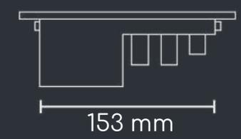
Su montaje requiere de un orificio de 163 x 51 mm.
