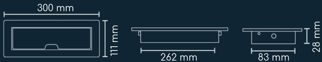
Su montaje requiere de un orificio de 272 x 86 mm.
